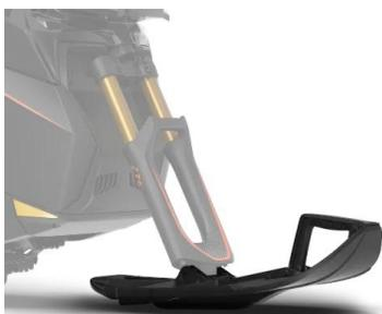
Le WS250 est guidé par un seul ski, conçu sur mesure par les ingénieurs de Widescape et fabriqué au Canada. Le ski et la chenille sont de la même largeur, améliorant ainsi la maniabilité et l'équilibre du véhicule.
