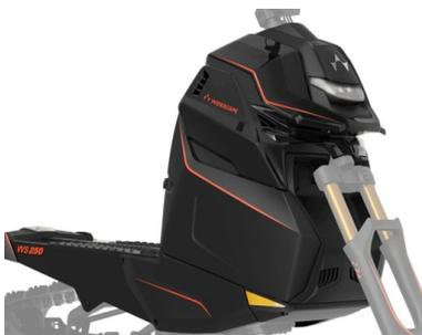
Le châssis et le cadre du WS250 sont composés entièrement d'aluminium, ce qui rend le véhicule très léger tout en étant robuste. À 200 livres, c'est la motoneige la plus légère sur le marché.
