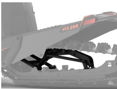
Une suspension avant et arrière de haute performance garantit une expérience de conduite plaisante et confortable sur tout type de terrain grâce au débattement de la suspension avant de 140 mm et de 100 mm à l'arrière.
