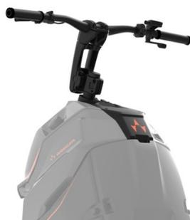
Un accélérateur à pouce permet une facilité d'usage et assure une puissance de sortie fluide, particulièrement utile lorsque l'on conduit dans les sous-bois.
